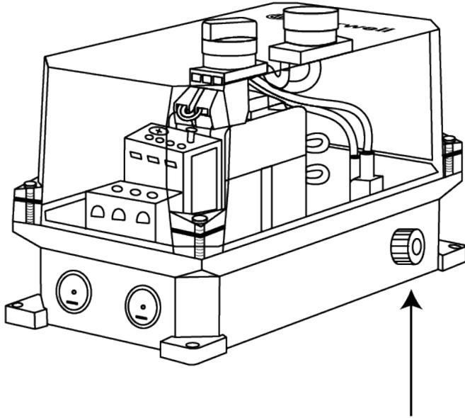
2. Inserte un extremo de la manguera flexible al switch neumático integrado en el arrancador y el otro extremo al botón pulsador.
